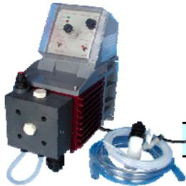
Elektromagnetische Dosierpumpe mit selbstreinigendem Kopf, geeignet zur Dosierung v. Kalkmilch zur Wasseraufhärtung, mit Schlauchset/Ansaugfilter/Dosierventil; 230 Volt
