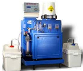
Mess- und Dosiergerät Chlor-Granulat, Säure und Flockmittel,
