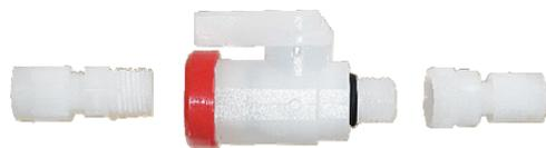
PVDF-Mini-2-Wege-Kugelhahn, AG 1/4" x IG 1/4", DN 6, PN 10, FPM/PTFE-Dichtung mit seith. Montagebügel, Montage z. B. mit beiliegendem Kabelbinder I-5218
