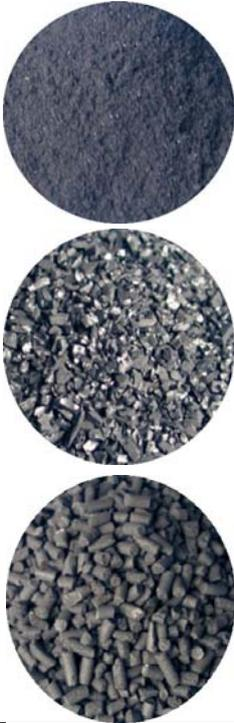
Aktivkohle wird als Filtermedium für Flüssigkeiten und Luft/Gase eingesetzt. Granulate und Pulver werden überwiegend zur Wasseraufbereitung eingesetzt, Formkohle meist für die Luftreinigung, aber auch für einige spezielle Wasseraufbereitungsgebiete, z. B. in der Aquaristik. Die in Deutschland verbreitetste Aktivkohle wird auf Steinkohlebasis hergestellt. Aktivkohle auf Kokosnussbasis ist noch abriebfester als solche auf Steinkohlebasis.
