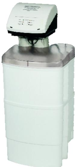
Kompakte Anlage mit 2 Druckflaschen, Solebehälter und kompletter integrierter elektromechanischer Mengensteuerung, Desinfektionsautomatik, Verschneide- u. Soleschwimmerventil, Druckflaschen gefüllt m. Trinkwasser-Kationen-Austauscher, Salztabletten beiliegend und vor Ort einzufüllen.
