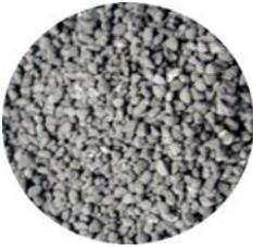
Birm dient der Enteisung/Entmanganung. Es enthält einen Katalysator, der in Verbindung mit Sauerstoff (siehe SVENT, Seite 3) zu einer Ausfällung von Eisen und Mangan führt. Diese Ausfällungen können dann abgefiltert werden. Für optimale Ergebnisse soll der pH-Wert bei der Enteisung über 6,8 und bei der Entmanganung zwischen 8 und 9 liegen. Standard-Korngröße: 0,6 mm. Schüttgewicht: ca. 600 - 800 kg/m<sup>3</sup>;
