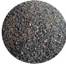
Greensand oxidiert Eisen / Mangan im Wasser.
