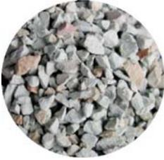
Zeolith ist ein vulkanisches Filtermaterial, das als molekulares Sieb wirkt. Es adsorbiert z. B. Ammoniumverbindungen aus Schwimmbadwasser und fixiert Schwermetalle (Zn, Cu, Cr, Pb, As) aus Abwassern. Standard-Körnung: 2,5 - 5 mm; Schüttgewicht: ca. 800 kg/m<sup>3</sup>
