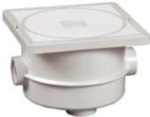
Anschlussdose, ABS, mit 1 bodenseitigen Gewindeöffnung und 2 Seitenöffnungen mit einem optionalen Zugang; mit Kabelklemme, Anschlußklemmen, Deckeldichtung; IP 47 (IP 47 = Schutz gegen Eindringen von Wasser mit schädlicher Wirkung bei zeitweiligem Eintauchen in Wasser)
