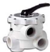
5 Anschlüsse IG 1,5" offen, Anschlüsse "Filter Inlet unten" und "Filter Outlet seitlich" geschlossen + 1 Anschluß IG 1/4" offen für Manometer + 1 Stopfen AG 1/4"
