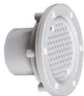
Groß-Einlaufdüse mit verstellbarem großem Siebkopf für Folienbecken, Anschluss Innengewinde 2 Zoll + 63 mm Klebe- mufte, Dichtung, Cofies, Gesamtdurchmesser vorne: 135 mm
