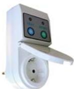
Betriebsfertig, als Adapter direkt für Steckdose, Nennstrom: 16 A, Spannung: 230 V / 50 Hz, Leistung: 3600 W, Bemessungsfehlerstrom: 40 mA, Auslösezeit: < 30 mS, Schutzklasse: IP 44, allpolige Abschaltung, mit Test- und Reset-Taste
